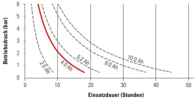
**Ausbringungsmenge\* REC 15 AC1 (Düsenstellung Sprühen)**
