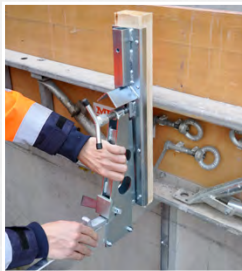
Ausrichten des Richtschlittens
