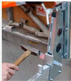
Querkeil des Schlittens festziehen
