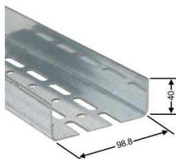
Rigips UA 100 ist ein leistungsfähiges Systemprofil von Rigips, welches zur Erstellung von verstärkten Unterkonstruktionen in Rigips Gipsplattensystemen dient. Rigips UA-Profile entsprechen den Vorgaben der DIN 18182-1 und der DIN EN 14195. Sie werden aus weichen, nicht legierten Stählen mittels Kaltverformung gefertigt. Rigips Profile sind gemäss Rigips Verarbeitungsrichtlinien Trockenbau zu verarbeiten.
