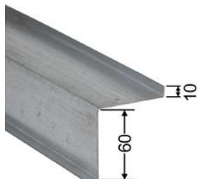
Rigips Inneneckprofile LWI sind leistungsfähige Systemprofile von Rigips, welche zur Erstellung von Unterkonstruktionen in Rigips Gipsplattensystemen dienen. Rigips Inneneckprofile LWI entsprechen den Vorgaben der DIN 18182-1 und der DIN EN 14195. Sie werden aus weichen, nicht legierten Stählen mittels Kaltverformung gefertigt. Rigips Profile sind gemäss Rigips Verarbeitungsrichtlinien Trockenbau zu verarbeiten.
