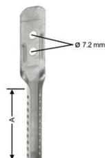
Rigips Noniusabhänger für CD-Profile dienen der drucksteifen Abhängung von Unterkonstruktionen für Rigips Deckensysteme. Der Rigips Noniusabhänger wird dabei in Verbindung mit einem Nonius-Justierstab an der Rohdecke mit dem Rigips Deckennagel befestigt. Die durchgehende Lochung erlaubt eine Einstellung der Abhänghöhe. Die Sicherung erfolgt mit Rigips Nonius-Klammern.
