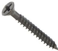
Rigips Schnellbauschrauben SBL dienen zur Befestigung von Rigiton® Ambiance Spachtelfuge Lochplatten auf Metallprofile in Rigips Lochplattensystemen. Rigips-Schnellbauschrauben SBL werden aus Stahl gefertigt und entsprechen den Vorgaben der DIN EN 14566. Sie verfügen über einen Trompetenkopf, ein Doppelganggewinde und eine Nagelspitze. Sie werden zur Befestigung von Gipsplatten auf Metallunterkonstruktionen aus Stahlblech  $\leq 0.7$  mm verwendet.
