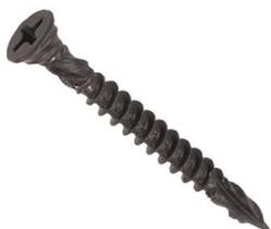
SHBS Schrauben dienen zur Befestigung von Sonderplatten wie Habito und Habito H kernimprägniert auf Metallprofile in Rigips Gipsplattensystemen. SHBS Schrauben werden aus Stahl gefertigt und entsprechen den Vorgaben der DIN EN 14566. Sie verfügen über einen Trompetenkopf, ein Gegengewinde und eine Nagelspitze. Sie werden zur Befestigung von Gipsplatten auf Metallunterkonstruktionen aus Stahlblech  $\leq 0.7$  mm in Rigips Gipsplattensystemen verwendet.
