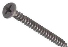
Die Rigips Hartfix Schnellbauschrauben wurden zur optimalen Befestigung der Rigips Riduro Holzbauplatte, der Rigips Duraline sowie der Rigips XRoc Strahlenschutzplatte entwickelt. Hartfix Schnellbauschrauben werden aus Stahl gefertigt und weisen ein gegenläufiges Gewinde unterhalb des Schraubenkopfes auf. Sie verfügen zusätzlich über einen Schneidringkopf zur optimalen Versenkung der Schrauben.
