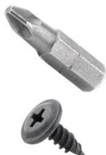
Blechschauben BS 2110 dienen zur Verbindung (Blech auf Blech) von Unterkonstruktionen in Rigips Gipsplattensystemen. Blechschauben BS 2110 werden aus Stahl gefertigt und verfügen über einen Flachrundkopf, ein Blechschaubengewinde und eine Nagelspitze. Sie werden zur Verschraubung von Blechen  $\leq 1.0$  mm verwendet.
