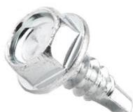
Bohrschrauben BS 7210 dienen zur Verbindung (Blech auf Blech) von Unterkonstruktionen in Rigips Gipsplattensystemen. Bohrerschrauben BS 7210 werden aus Stahl gefertigt und verfügen über einen 6-Kant-Kopf, ein Feingewinde und eine Bohrspitze. Sie werden zur Verschraubung von Blechen  $\leq 4.0$  mm verwendet.
