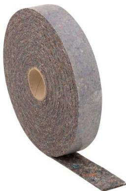
Rigips Filzstreifen, zweiseitig selbstklebend werden als Anschlussdichtung unter Rigips Wandprofilen zum Anschluss an Bauteile aus Beton, Mauerwerk oder Holz und zur rückseitigen Verbindung von Rigips C-Wandprofilen in Doppelständerwänden verwendet.
