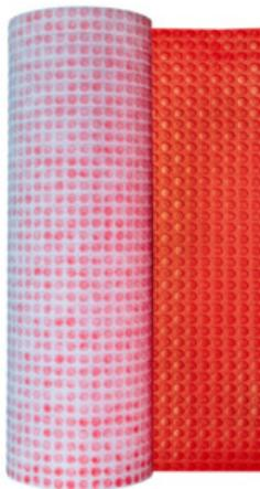
Rissüberbrückende, bahnenförmige Spezial-EntkopplungsMatte aus hochwertigem Hart-Polyethylen (HDPE), mit hinterschnittenen Vertiefungen, unterseitig mit einem Trägervlies aus Polypropylen. Für kritische, gerissene und nicht vollständig ausgetrocknete Untergründe vor der Verlegung von Fliesen- und Naturwerksteinbelägen. Geeignet für Renovierung, Sanierung und Neubau.
