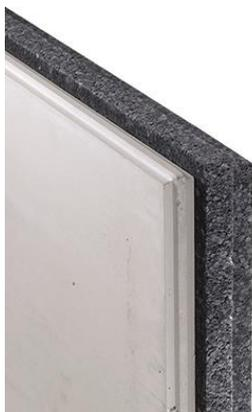
Werkmässig aus Calciumsulfat und Wasser hergestelltes Bauteil der Rohdichteklasse M, das Fasern und Zuschlagstoffe enthält. Aufkaschiert mit expandiertem Polystyrol EPS 15 sind Alba<sup>®</sup> therm Verbundplatten der ideale Baustoff für eine optimale Innendämmung.
