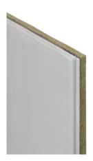
Werkmässig aus Calciumsulfat und Wasser hergestelltes Bauteil der Rohdichteklasse M, das Fasern und Zuschlagstoffe enthält. Aufkaschiert mit Mineralfaserdämmstoff sind Alba®phon Verbundplatten der ideale Baustoff für eine optimale Innendämmung.
